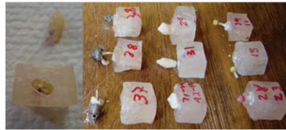
Fotografía 5. Muestras sometidas a la fuerza de compresión lateral que provoca fractura a nivel del tercio cervical, con el desalojo del poste.
