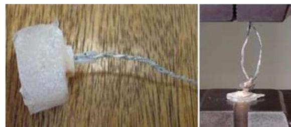
Fotografía 6. Muestras sometidas a la fuerza de tracción, se desaloja el poste y provoca la fractura de la raíz.
