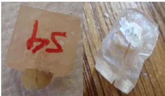
Fotografía 4. Muestras sometidas a la fuerza de compresión vertical, que provoca la fractura longitudinal de la raíz.
